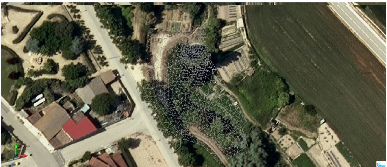
Pas de malla utilitzat a cada zona (dalt). Malla generada (baix)
